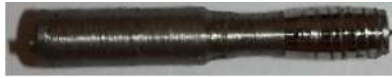
Figura 6 Resultat obtingut de l'intent de fabricació de la peça a escala real
