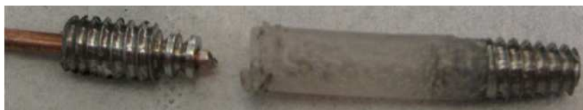
Figura 12 Resultat final d'una de les pròtesis desemmotllada
