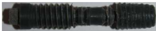
Figura 1 Conjunt complet de peces fabricat amb PVC i a escala 2:1 amb el torn Okuma
