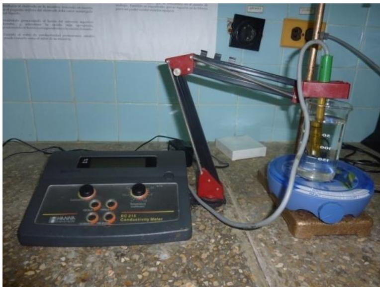
Figura 13: Conductímetro. Fuente: AQUA (2011)
