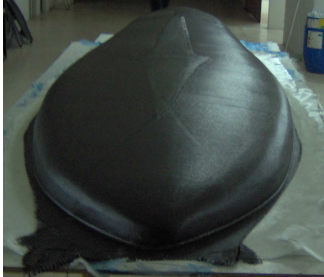
Fig.4 Participació de voluntaris: Fabricació de la carrosseria en fibra de carboni. Treballs de muntatge del vehicle.
