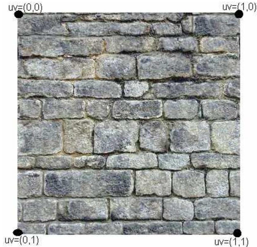
Figura 3.36, aquest exemple ens indica els valors que s'haurien d'assignar a la variable de tipus texcoord perquè un billboard mostrés tota aquesta imatge.
