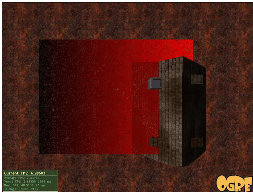
Figura 3.24, imatge capturada al fer proves sobre el bon funcionament de la normalització de posicions, com veiem a l'esquerra, tots els valors de color seran zero, i en mica en mica que es va arribant cap a la dreta de la imatge, es va veient com el color vermell és més intents.
