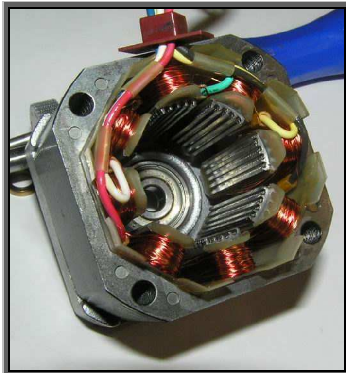
Fig.7 Rotor d'un motor pas a pas de 200 pasos per volta. Es veu el mecanitzat per aconseguir els micropols i els 6 fils del motor.
