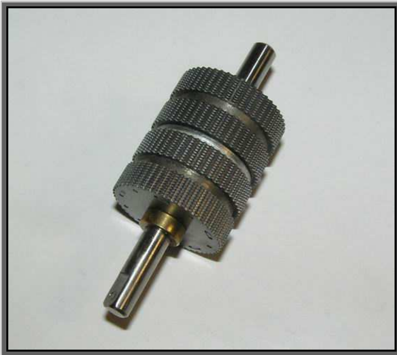
Fig.6 Rotor d'un motor pas a pas de 200 pasos per volta. On es veuen els micropols creats per la mecanització de rotor
