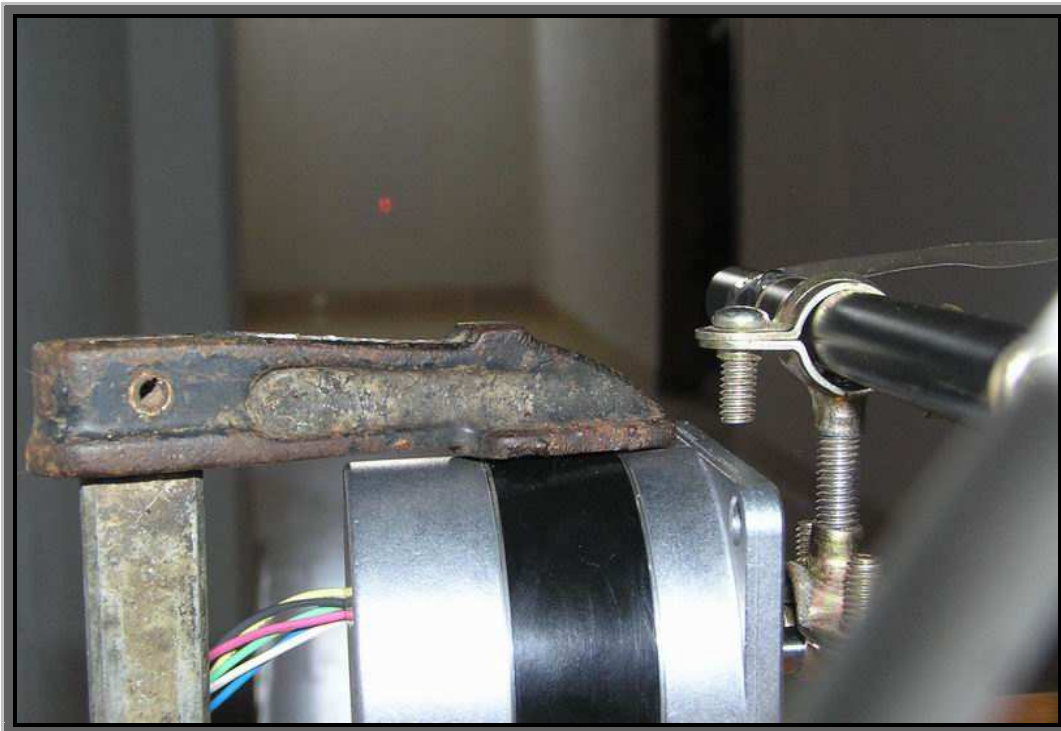
Fig. 31 Laser subjectat al motor i aquest a una taula. Al fons es veu la llum del laser projectada a un full de paper per a poder fer les medicions.
