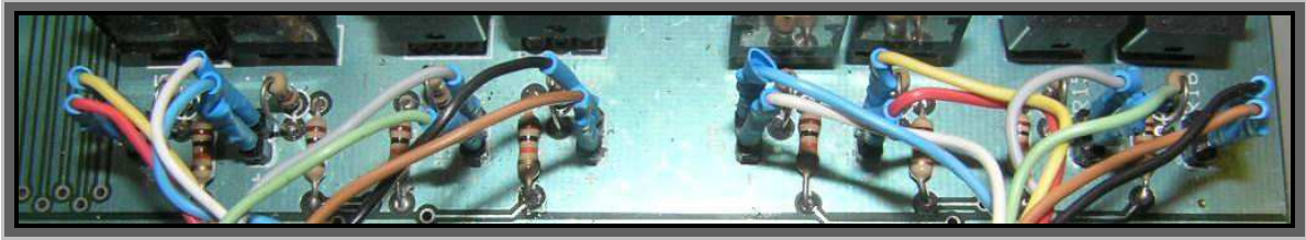
Fig.12. Connectors i resistències del visualitzador de fases del motor.
