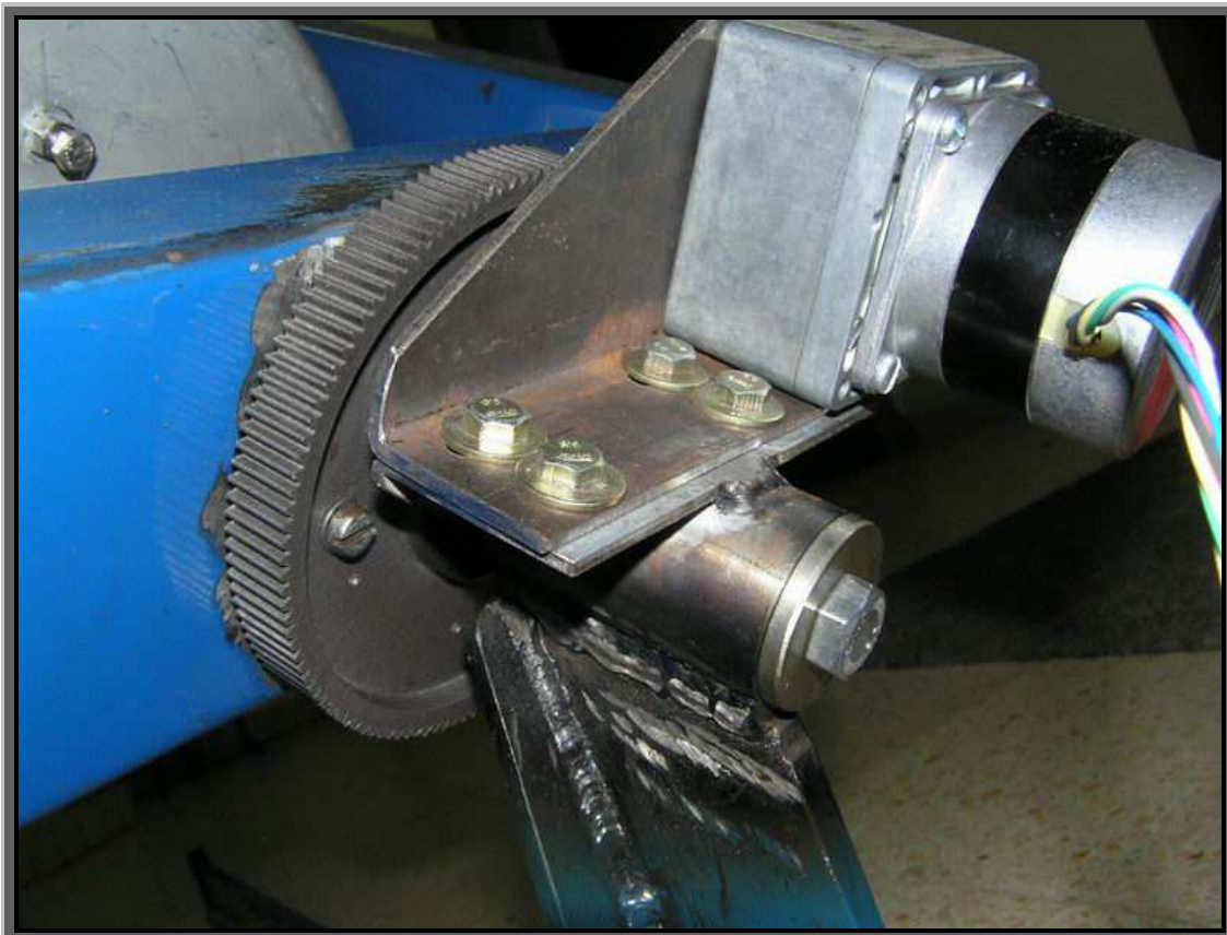
Fig. 39 Mecanisme de l'eix d'ascensió recta.
