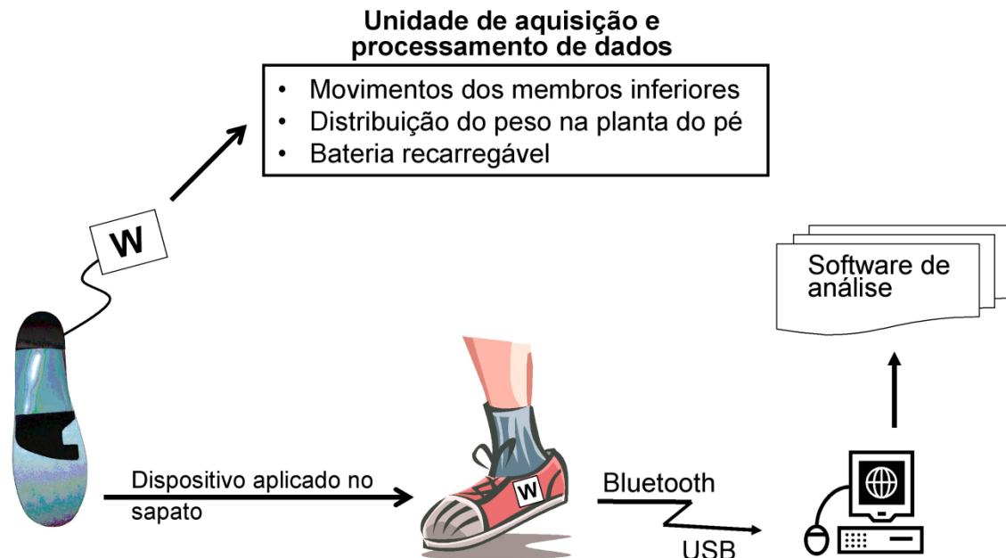
Figura 19 – Unidade de aquisição e tratamento de dados de pressão,
