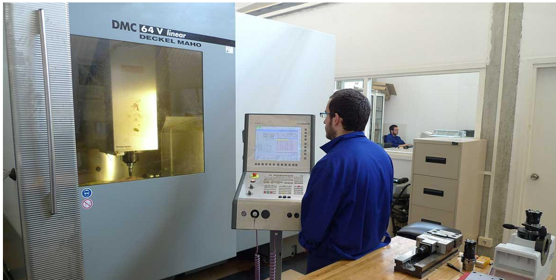
Figura 31 – Fotomontagem onde se pode ver na sala ao fundo o operador a trabalhar sobre o ambiente CAM (no caso o software GOELAN) e em primeiro plano o servidor da máquina com o comando de controlo numérico bem como do lado esquerdo a peça a ser fresada.
