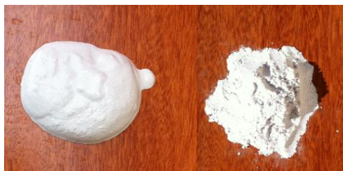
Fig 6.2 A l'esquerra pols de vidre original, a la dreta pols de vidre després del mostreig.
