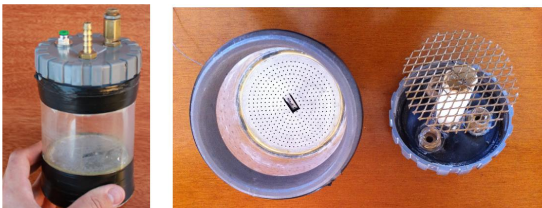
Fig 5.10 A l'esquerra electro-filtre muntat. A la dreta, desmuntat.
