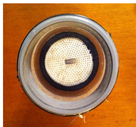
Fig 5.16 Vista en planta de l'electro-filtre. S'observa el càtode, medi filtrant i junta de goma.
