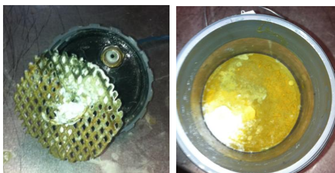
Fig 7.4 A l'esquerra pols de vidre adherida a l'ànode per l'efecte d'electroforesi. A la dreta tortó format després de 15 min d'electrofiltració amb 0,45% NaCl i 30V.
