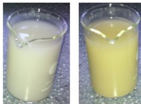
Fig 7.5 A l'esquerra mostra de pols de vidre original. A la dreta tortó dissolt en aigua després de 15 min d'electrofiltració amb 0,45% NaCl i 30V.
