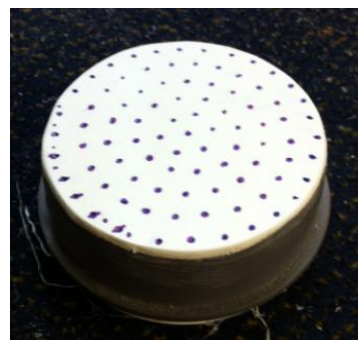
Fig 5.9 Cercle de PVC del tap cec (suport càtode) abans de ser perforat.
