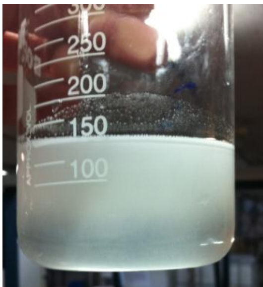
Fig 7.10 Filtrat gasificat. En la part inferior del vas de precipitats s'observa com es va desgasificant.
