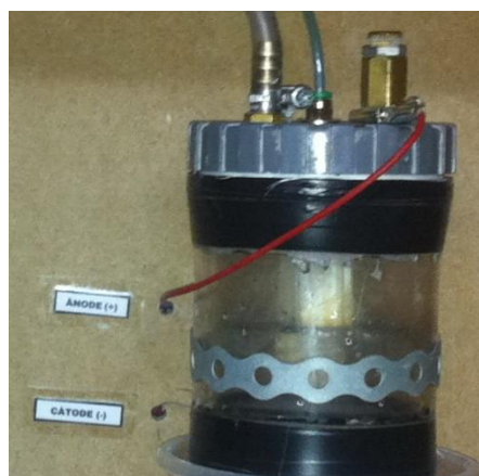
Fig 5.14 A l'esquerra font d'alimentació. A la dreta connexió de l'ànode i del càtode amb la font d'alimentació.
