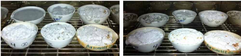
Fig 7.7 A l'esquerra tortó humit, a la dreta tortó sec després d'estar 24 h a 105°C.
