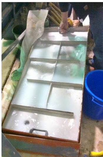
Fig 6.1 Sistema col·lector de la pols de vidre.
