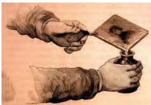
52. Bany de la placa en un concentrat de sal comú per insensibilitzar les zones de plata actives a la llum.
