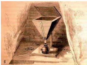
51. Procés d'exposar la placa als gasos de mercuri per tal de provocar el revelat d'aquesta.
