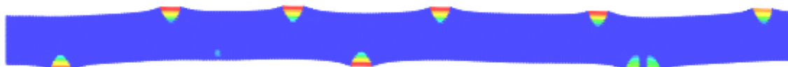
Figura 5.38: Agrietamiento de un laminado [90, 0]_s . Se muestra la deformación principal máxima. Deformada aumentada 30 veces.
