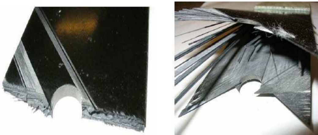
Figura 5.7: Fallo de dos piezas fabricadas con el mismo material y orientación pero con distintos espesores de láminas. La imagen de la izquierda corresponde a láminas de espesor pequeño mientras en la de la derecha las láminas son más gruesas y permiten la delaminación. Imagen de Green et al. [201]
