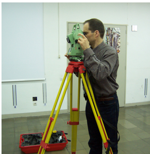
Figura 7.15 Mesura de la posició dels reflectors mitjançant un teodolit electrònic
