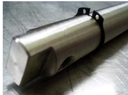
Figura 15: Exemple d'una aplicació de l'operació de ranurat
