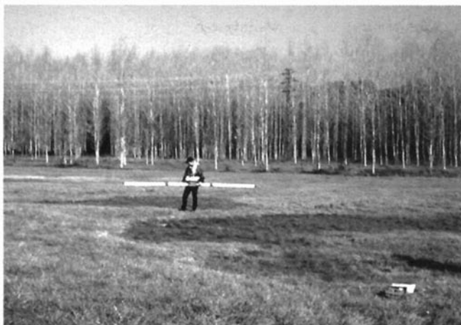
Figura 2. Imatge de l'equip EM 31 utilitzat per a la mesura de conductivitat del sòl.
