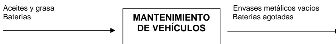
Figura 1: Principales materiales utilizados y generación de residuos especiales derivados de las operaciones de mantenimiento de vehículos
