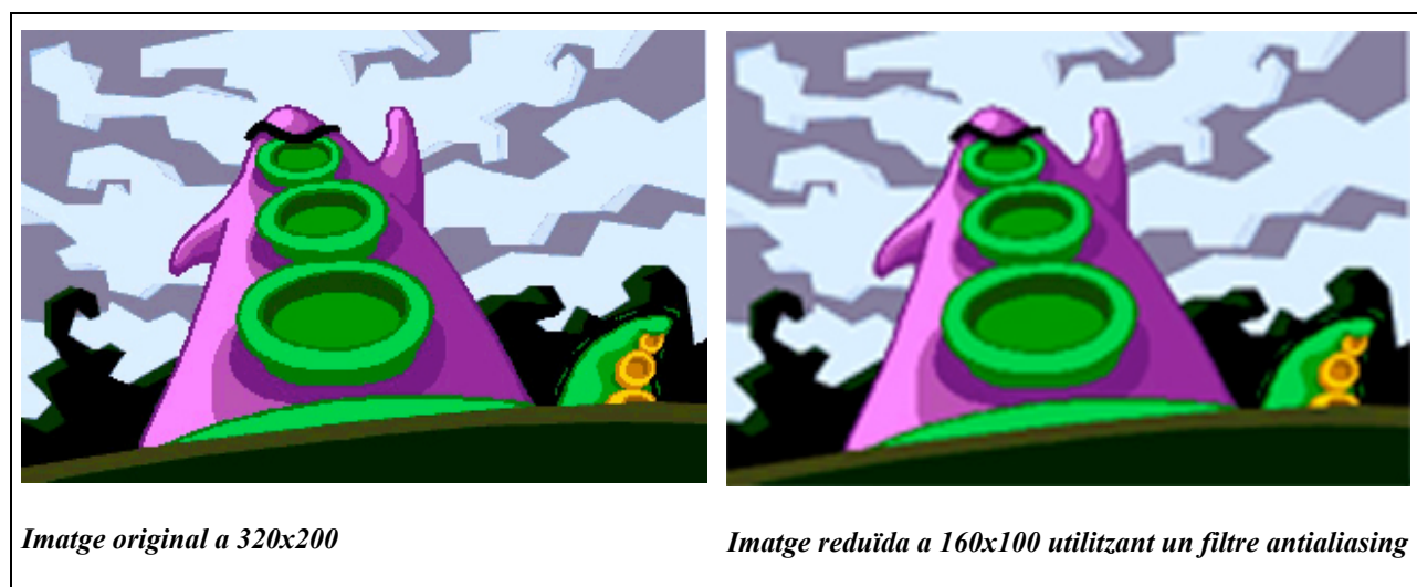
Fig 5.12 Exemple de reducció d'imatge utilitzant un filtre antialiasing.
