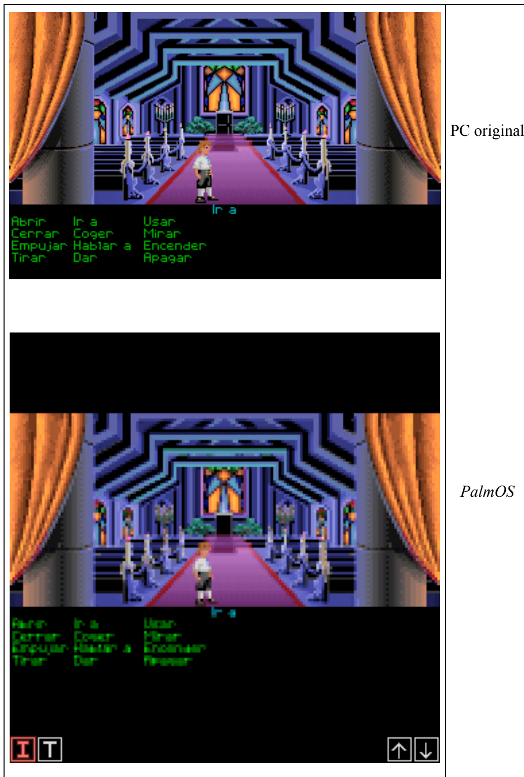
Fig 6.2 Captura de la reducció amb filtre utilitzant una matriu 2x2 comparada amb l'original
