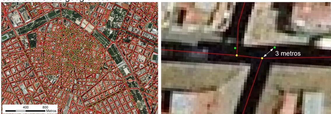
Figura . Ejemplo de extracción de los vértices del entramado urbano de Cartociudad (puntos amarillos) y detalle del error posicional de OpenStreetMap (puntos verdes).
