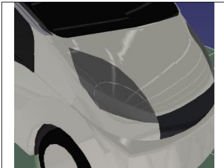
Figura A.32: dibuix en 3D de la modificació dels llums.
