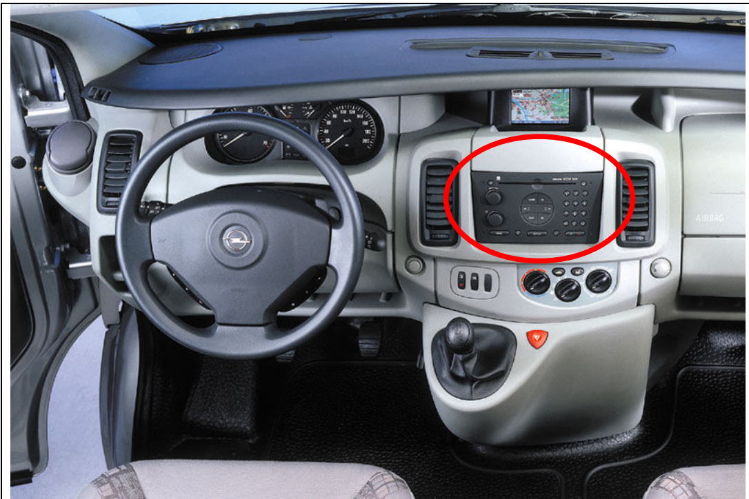
Figura A.6: encerclat trobem l'espai que ocupa el radio cassette i que podem aprofitar per a instal·lar-hi una pantalla.
