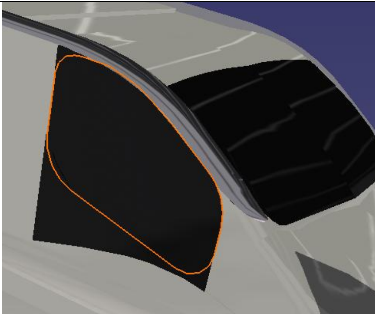
Figura A.32: dibuix en 3D de la modificació de la línia lateral, emmarcat en taronja està la finestra original.
