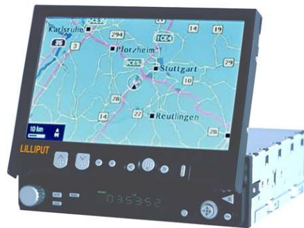
Figura A.7: pantalla que aprofita l'espai de la radio. Existeixen models on la pantalla entra dins de l'allotjament de la radio quedant amagada.
