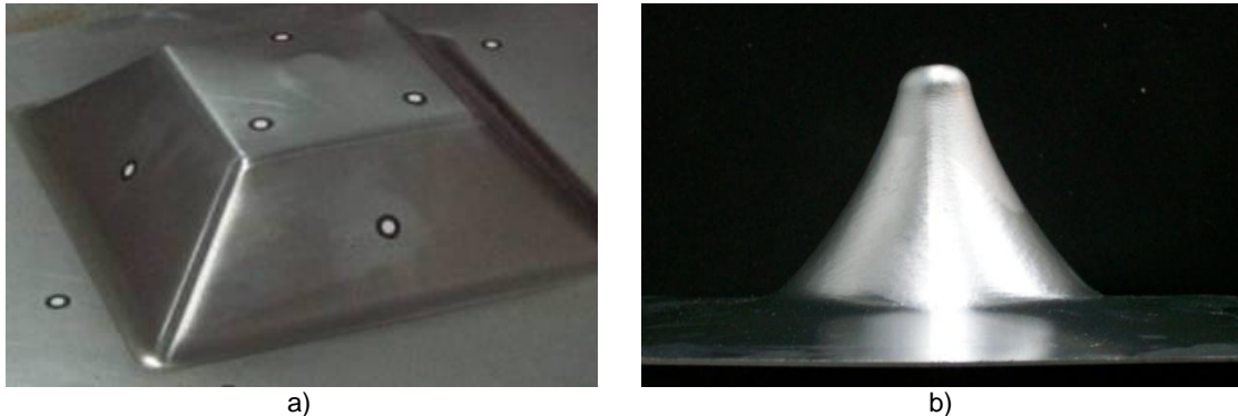
Figura 3.12. a) Piràmide truncada amb angle de paret constant. b) Con truncat amb angle de paret variable definit per un radi de generatriu.
