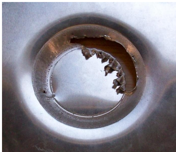
Figura 4.1. Exemple del resultat de deformar xapa d'alumini sense lubricant.
