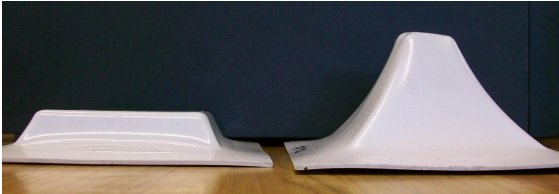
Figura 9.2. Exemple de dues peces de PVC fabricades amb la tecnologia ISF en el GREP.
