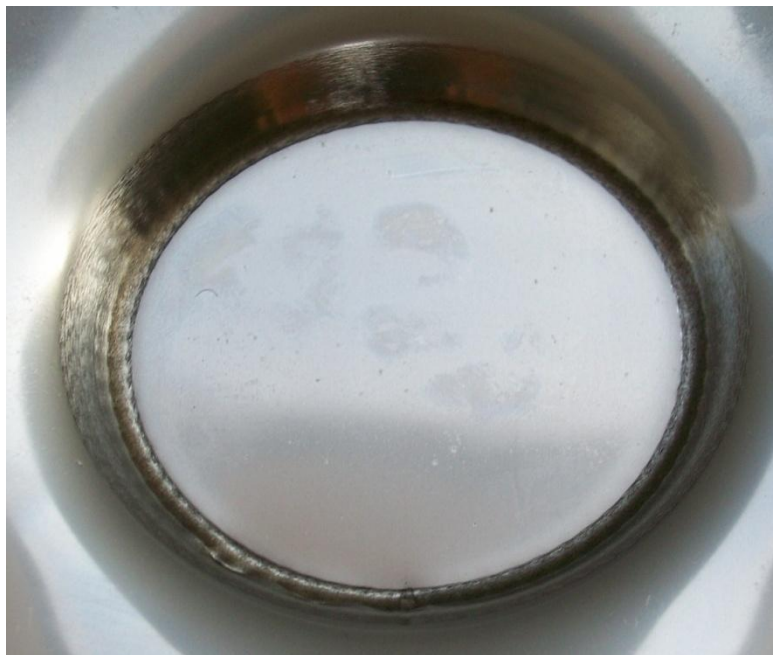
Figura 4.4. Exemple d'un acabat acceptable utilitzant oli lubricant amb l'acer inoxidable.
