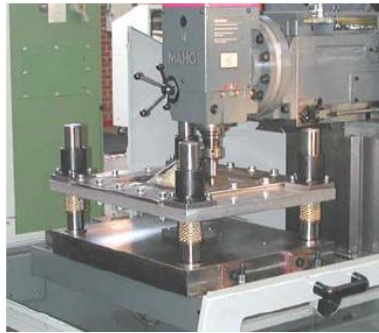
Figura A.8. Sistema de fixació de la xapa en un centre de mecanitzat CNC (Jeswiet et al., 2005).
