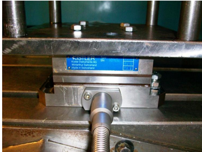
Figura B.2. Muntatge de la taula dinamomètrica Kistler a la taula de treball de la Kondia HS1000.
