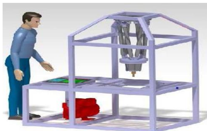
Figura A.11. Disseny d'una màquina per ISF a partir d'una plataforma Stewart (Marabuto et al., 2011).
