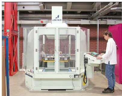
Figura A.9. Fotografia d'una màquina destinada a ISF de la marca AMINO (Jeswiet et al., 2005).
