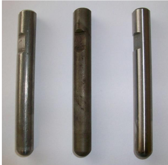
Figura 2.5. D'esquerra a dreta: eina acer F-1 sense tractar, eina d'acer F-1 tractada i eina de Vanadis 23.
