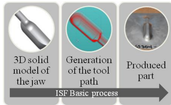
Figura A.14. Cadena de procés en la variant més simple de la tecnologia de ISF (Pérez-Santiago et al., 2011c).
