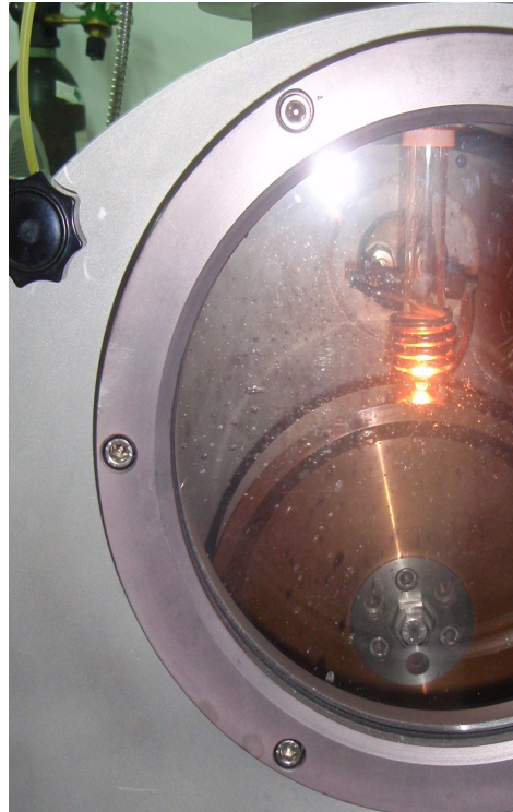
Fig. 52 En aquesta foto veiem com la mostra ja esta calenta i possiblement ja és líquida. La temperatura de la mostra en aquesta fotografia és del voltant de 1200°C.
