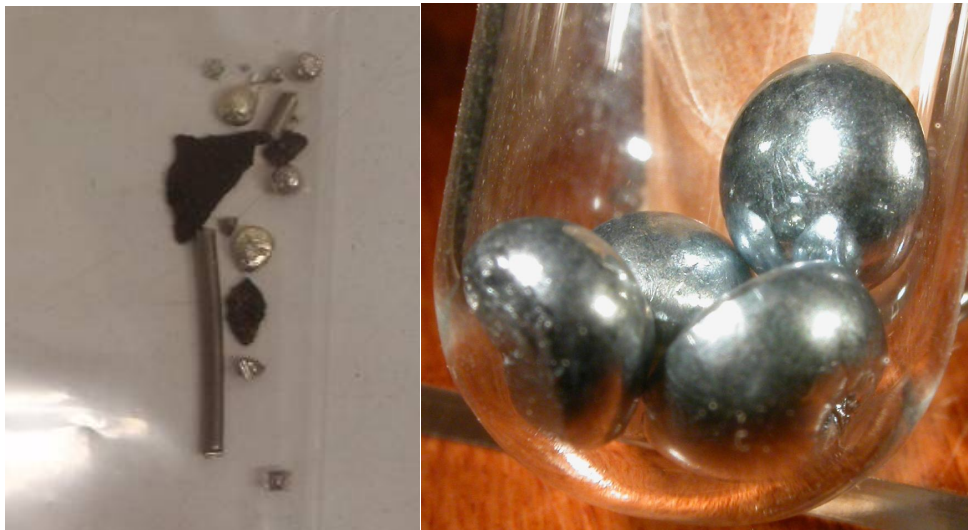
Fig. 47 Foto abans - després. A la figura de l'esquerra veiem els diferents elements dels quals es parteix; i a la figura de la dreta veiem les boles un cop treballades amb la tècnica de l'arc melting.
