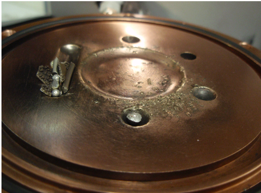
Fig. 48. Fotografia on es poden veure els precursors col·locats a la cavitat allargada de la dreta i la bola de titani a la cavitat semiesfèrica de davant.
