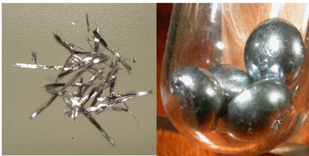
Fig. 50. A la fotografia de la dreta es veuen els precursors, és a dir, els massissos, mentre que a la esquerra es poden veure els productes, les cintes.
