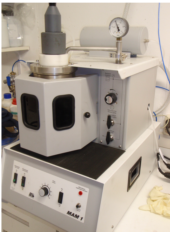
Fig. 49. Aparell d'arc melting disponible a la UdG
