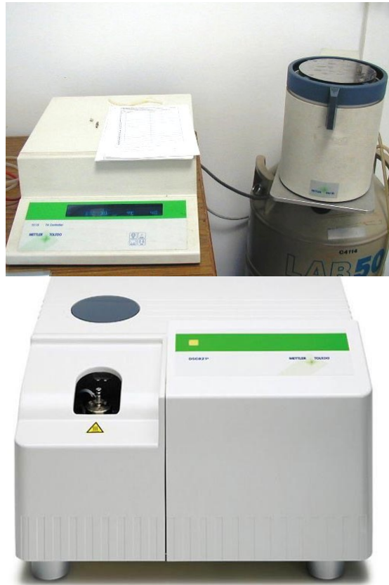
Fig. 61 Fotografia dels dos aparells de calorimetria de la UdG. A l'esquerra apareix el que s'utilitza per treballar a baixa temperatura, mentre que a la dreta el que treballa a alta temperatura.
