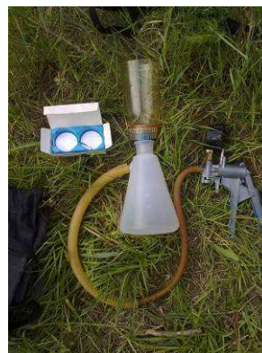
Figura 7.1: Equip de filtratge i filtres Whatman
