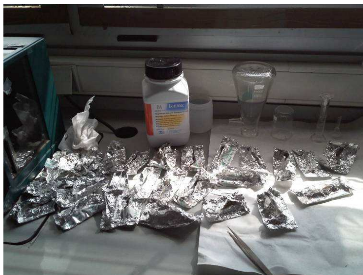
Figura 7.15: Filtres per a la determinació dels sòlids en suspensió, envoltats per paper d'alumini.
