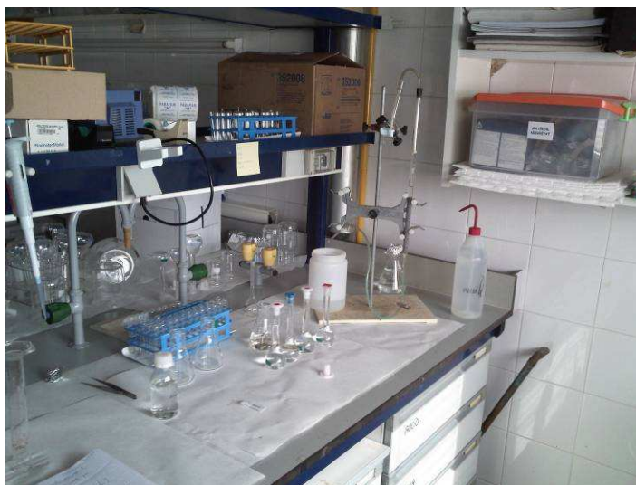
Figura 7.12: Columna reductora per a l'obtenció dels nitrats.
