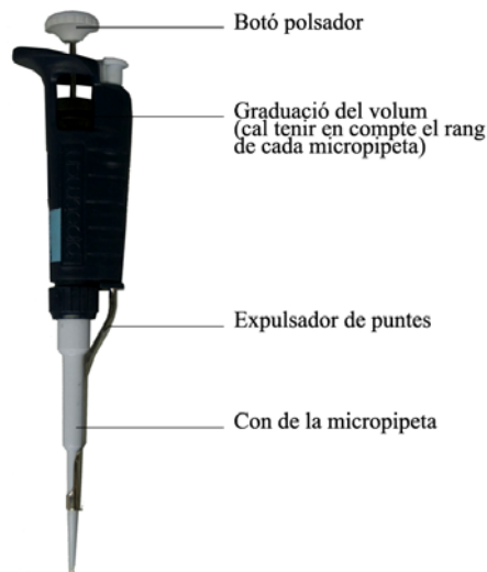
Figura 1.7. Esquema general d'una micropipeta. Autora: Silvia Barrabés.
