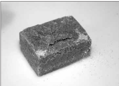
Imagen 3. El agua da cohesión a las arenas
