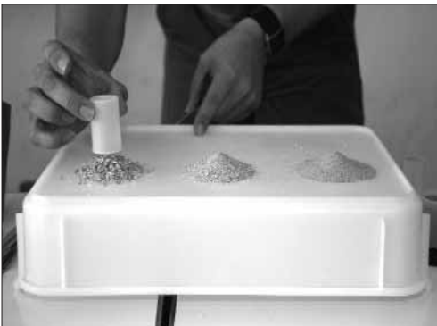
Imagen 1. El ángulo de estabilidad de las arenas finas es menor que el de las arenas gruesas o gravas
