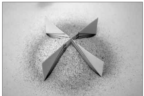
Imagen 2. Distintos valores angulares dibujados sobre una plantilla en forma de cruz nos permitirán determinar el ángulo de estabilidad de las muestras de arena
