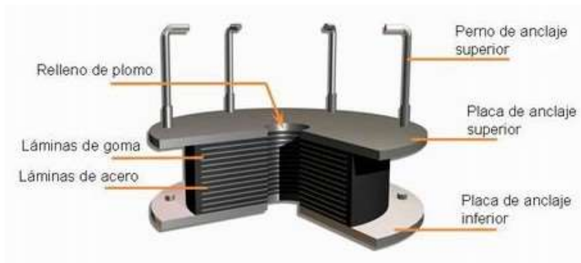
Figura A.1. Estructura aïllador sísmic
