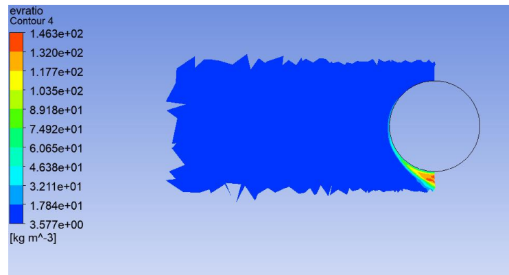
Figura 16: Eddy Viscosity Ratio del rotor llis a 2010 rad/s (font pròpia)
