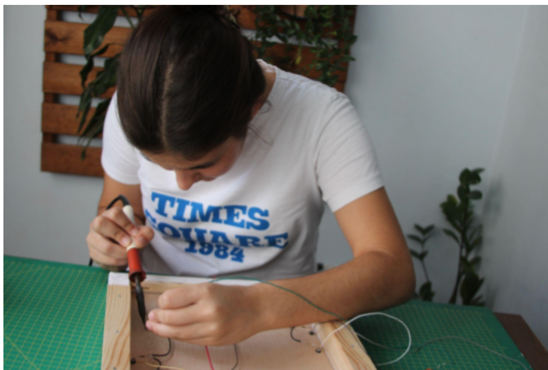
Figura 39. Soldant els cables de la instal·lació del Plafó 1.
