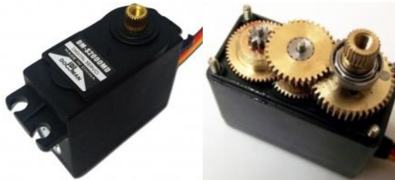
Figura 10. Servomotor DM-S2000MD pinyonera metàl·lica interna. (DOMAN RC, 2024)
