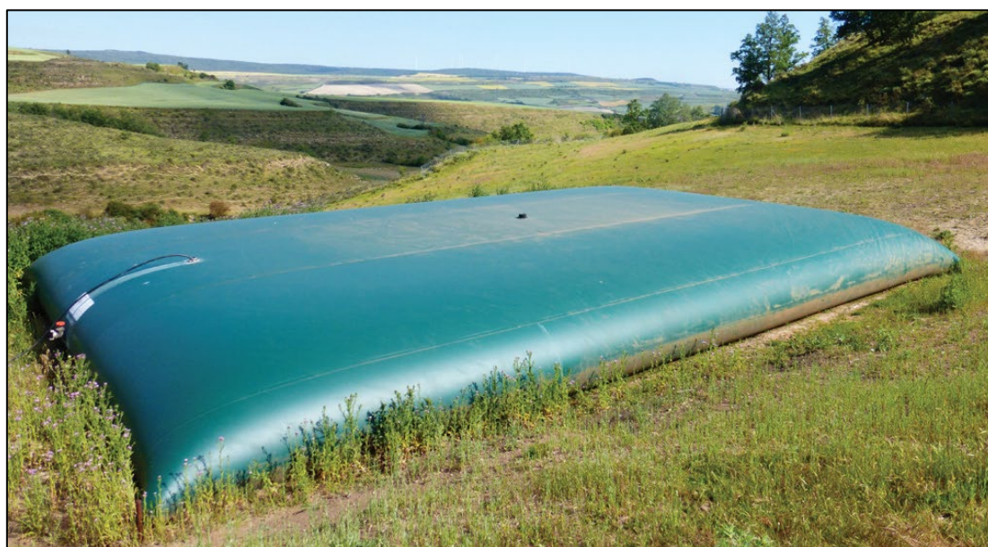
Figura 5.3: Exemple de tipologia de fossa de purins exterior que s'ha utilitzat per aquest projecte (37) .
