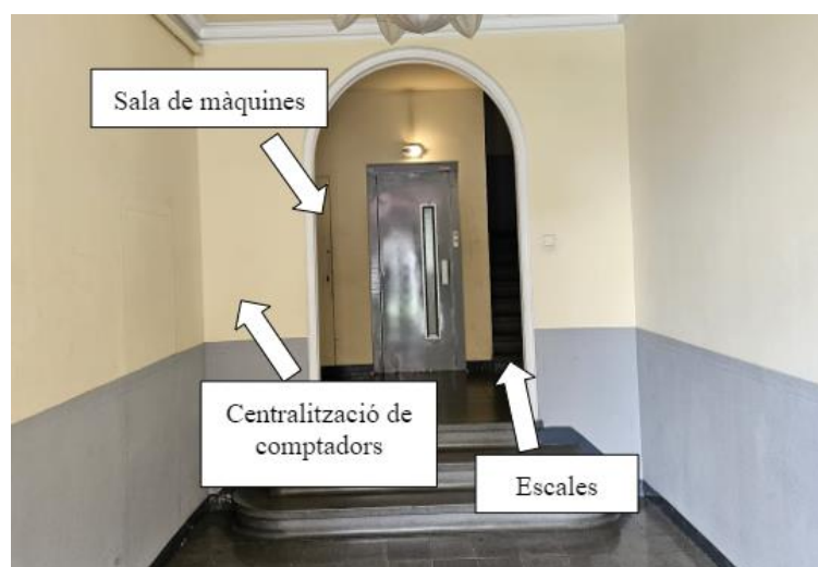
Figura 4: Distribució de l'entrada de l'edifici 1. Font: pròpia
