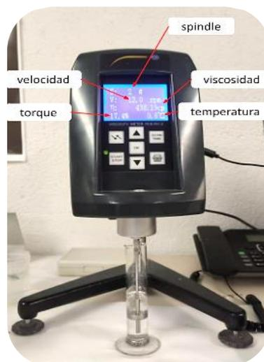
**Fig. 5.3.** Dispositivo PCE-RVI 2 y sus partes.
