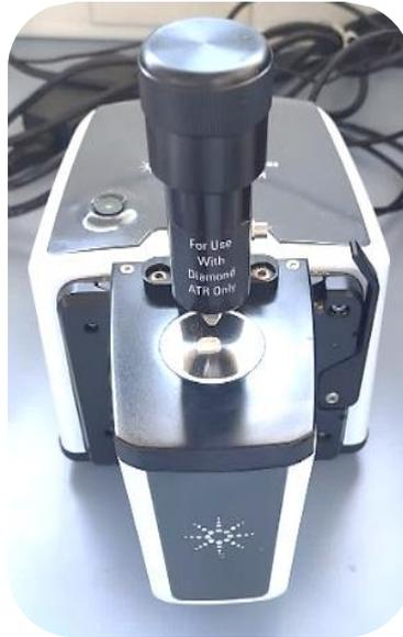
**Fig. 5.5.** Equipo de espectroscopia ATR-FTIR.
