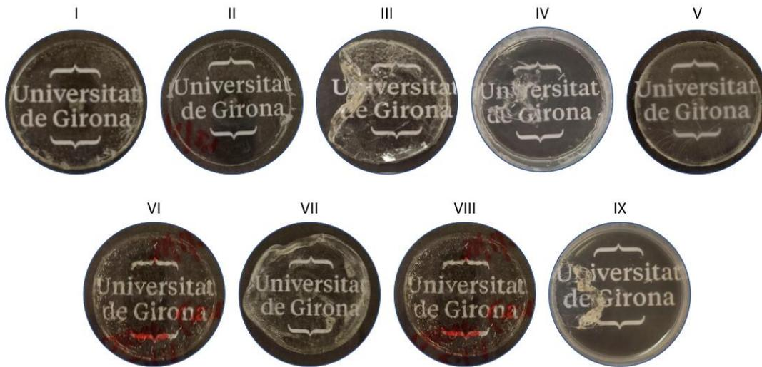
Fig. 6.2. Imagen de los eutectogeles polimerizados.
