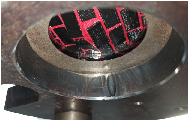
Figura 34: Fotografia de la part inferior d'una proveta durant l'assaig, es pot veure com els brics s'han començat a separar del TPU.
