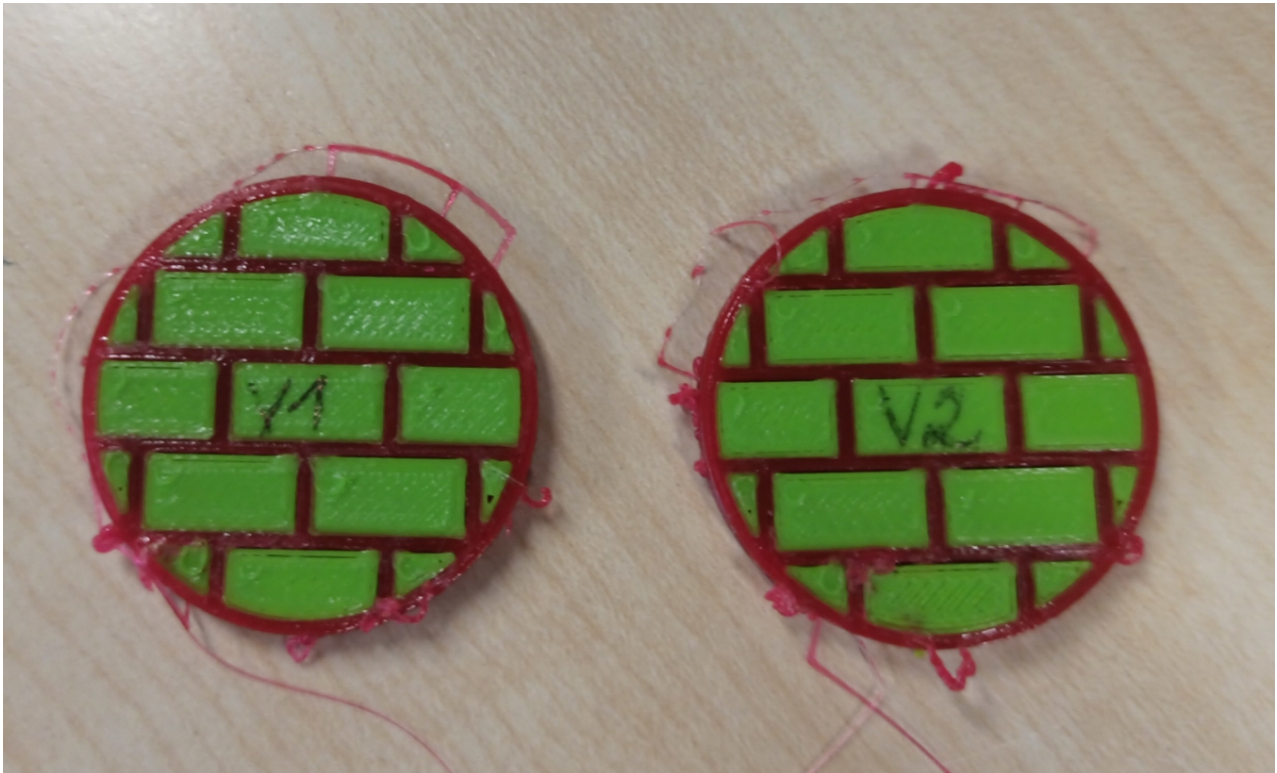
Figura 23: Proves d'impressió amb làmina entre nivells. No va haver-hi cap problema d'adherència entre els materials.
