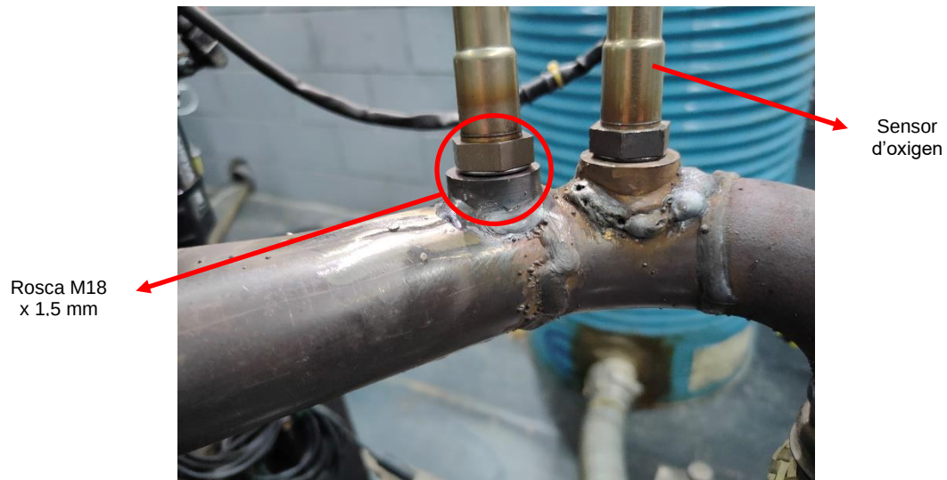
Figura 19. Muntatge del sensor d'oxigen al tub d'escapament.
