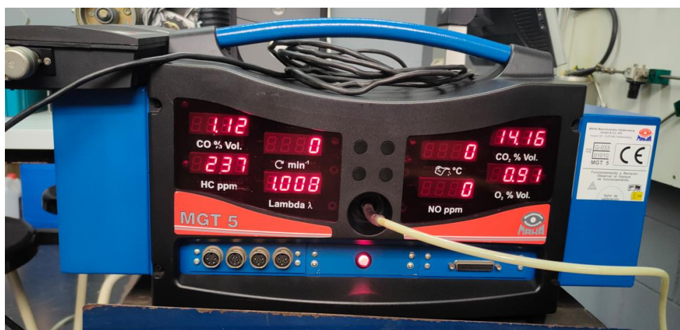
Figura 41. Detector de gasos MAHA MGT 5.
