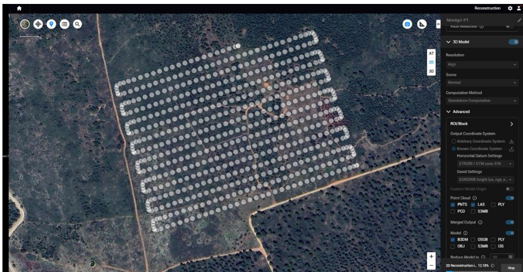
Figura 5. Quadre de treball del software DJI Terra. Cada punt gris representa una de les imatges captades pel dron que, en comunicar-se amb un GPS d’elevada precisió, permet obtenir les coordenades en que s’ha captat cada una de les imatges. (Aquesta és una imatge d’exemple, no correspon a l’àrea d’estudi d’aquest treball).
