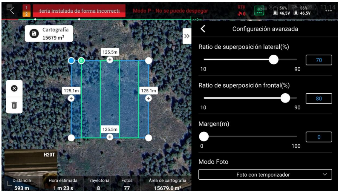
Figura 4. Quadre de treball del programa DJI Pilot 2. S’hi observa l’àrea d’estudi (en blau), la ruta de vol (en verd) i algunes de les possibles opcions de configuració i dades de vol. (Aquesta és una imatge d’exemple, no correspon a l’àrea d’estudi d’aquest treball).
