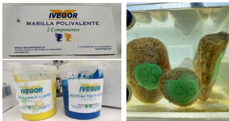
Figura 6. Components per obtenir la massilla (esquerra) i resultat de la numeració (dreta).
