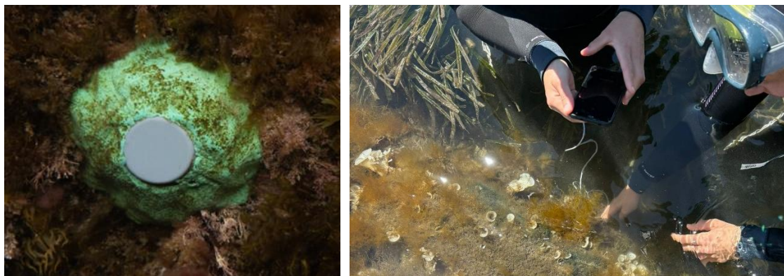
Figura 7. Sensor de temperatura (esquerra) i presa de mostres a partir de telèfon i cable (dreta)
