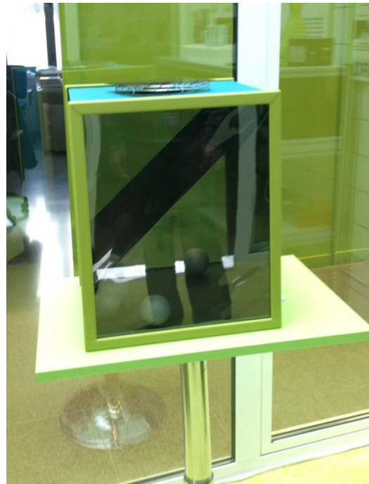
Figura 104. Capsa amb filtres transparents i dos polaritzadors entremig, que produeixen la il·lusió òptica d'haver-hi una separació entre dues parts.
