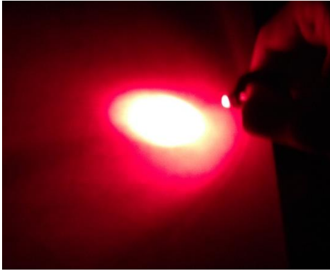
Figura 56. LED vermell incidint a la placa fosforescent.
