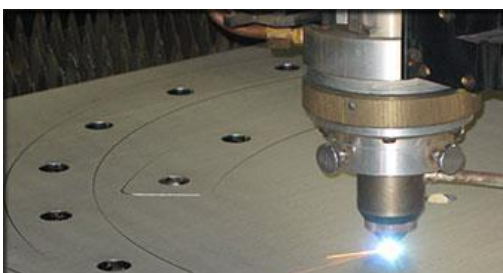
Figura 22. Làser industrial realitzant operacions de tall.
