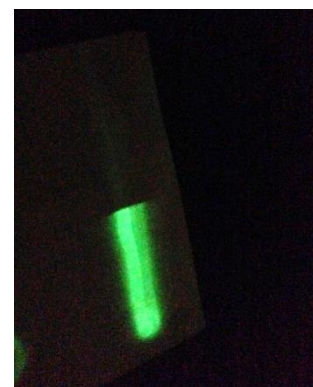
Figura 68. Placa fosforescent després de passar el LED blau per sobre els filtres.
