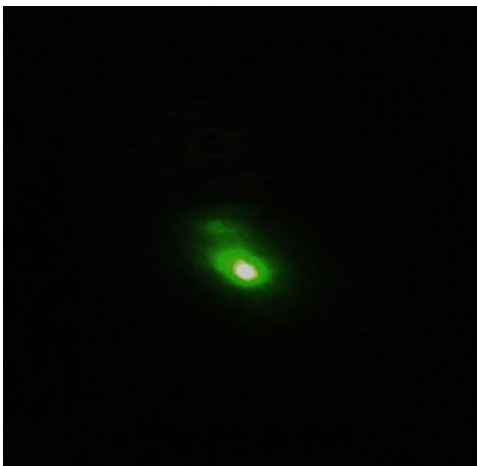
Figura 63. Làser verd incidint a la placa fosforescent.
