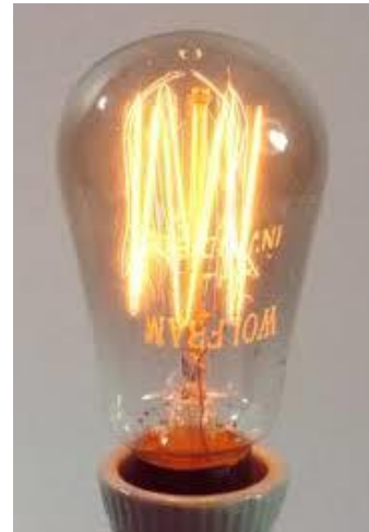
Figura 14. Bombeta incandescent amb filament de wolframi.
