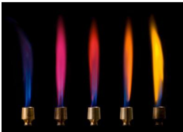
Figura 28. Assajos a la flama d'elements químics. Permeten determinar els espectres d'emissió.
