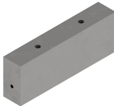
Figura 28: Renderitzat del bloc suport del rodament davanter
