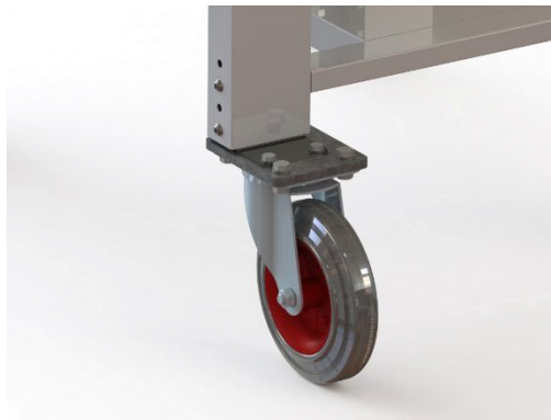
Figura 13: Renderitzat en detall de la platina que uneix la roda amb carretó
