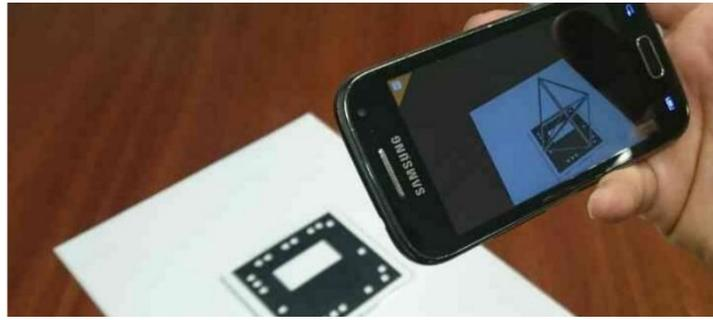
Figura 1. Representación de modelo 3D de RA en un móvil mediante uno de los marcadores fiduciales.
