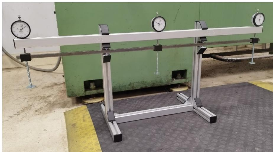
Fig. 2. Máquina de flexión.
