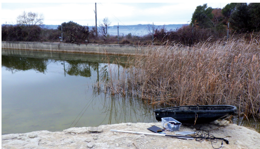
Figura 5: Material utilitzat per fer els mapes batimètrics i calcular el volum d'aigua a les basses.
