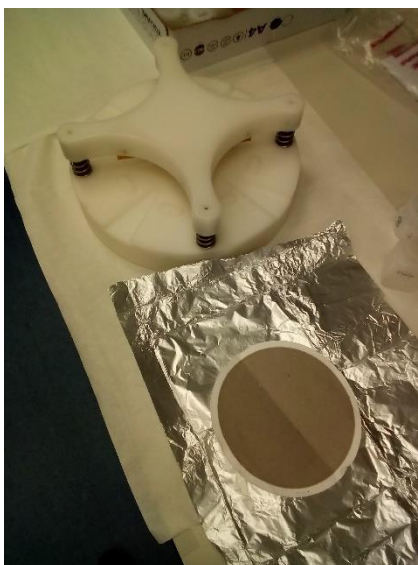
Aparell per tallar els filtres i filtre preparat per tallar. Font: Fotografia pròpia
