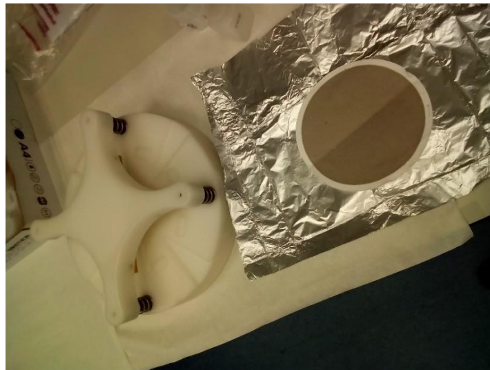
Imatge 2.3.1.1. Filtre de quars de 15 cm de diàmetre (Pallflex®) i un aparell per tallar-los en quatre parts. Font: Fotografia pròpia.
