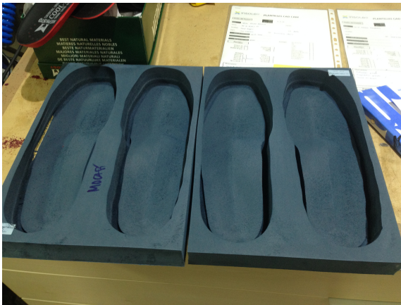
Fig. 6 Plantilles fetes amb la fresadora de Ortopèdia Soler.
