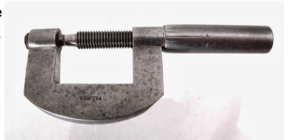
Fig. 3 Micròmetre de caragol creat per Maudslay
