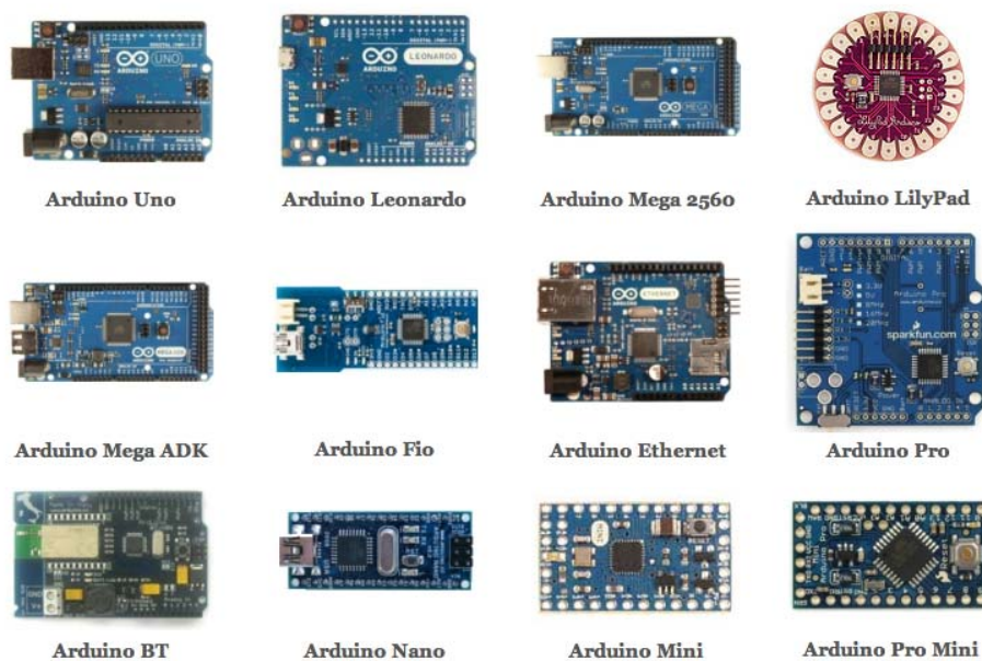
Fig. 11 Imatge de totes les plaques Arduino Font: https://underc0de.org/
