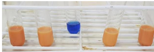
Imatge 85: Prova de Fehling en el sèrum de les llets de soja transgènica Vital (Light i normal)
