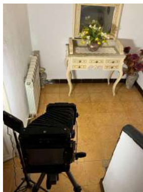
Figura 55. Col·locació de la càmera per fer la fotografia del mirall sense el reflex. (Laura Feixas, 2023)
