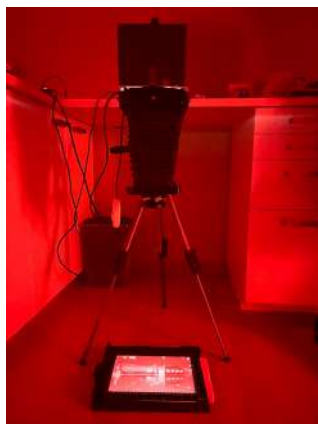
Figura 70. Ampliadora feta amb la càmera de gran format que he construït. (Laura Feixas, 2023)
