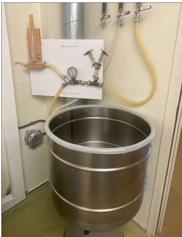
Figura 31: Tanc d'acer usat a la fase d'impregnació per a realitzar el buit de les peces ja tractades prèviament. Autor: Font pròpia.
