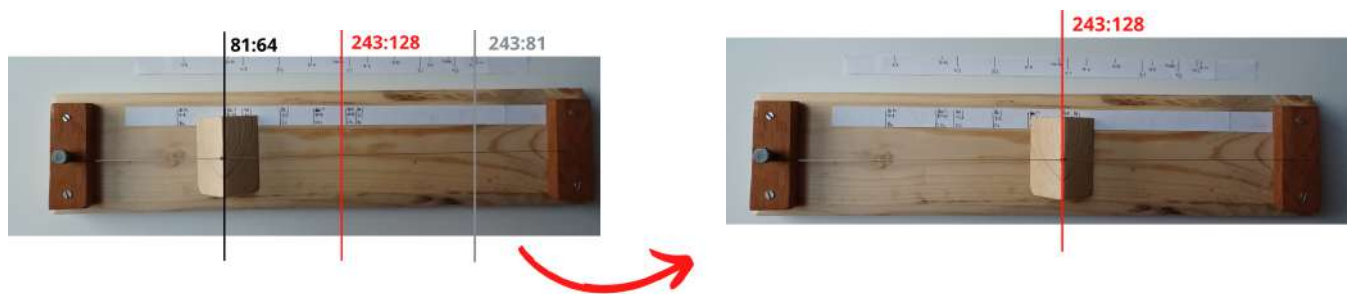
Imatge 71: Obtenció de la proporció 246:128 en el monocordi
