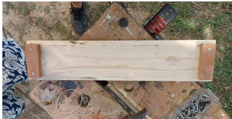
Imatge 53: Els dos ponts fixes clavats a la base de pi.
