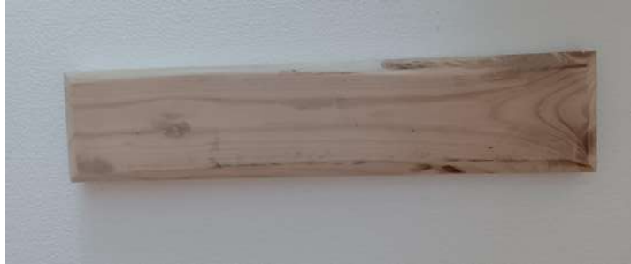
Imatge 51: Fusta base, de pi, llimada i polida.
