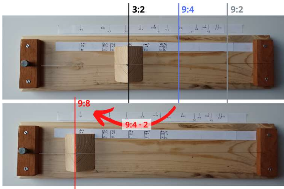
Imatge 68: obtenció de la proporció 9:8 en el monocordi
