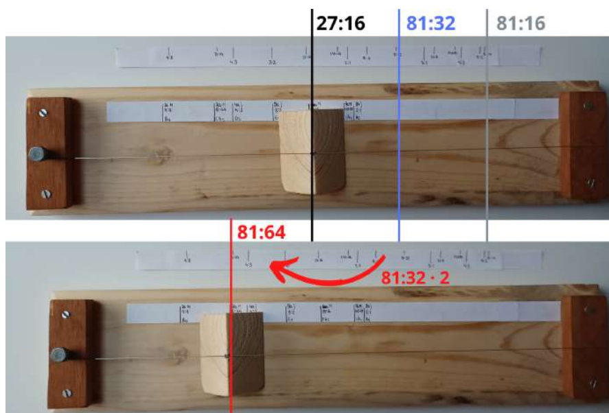
Imatge 70: Obtenció de la proporció 81:64 en el monocordi
