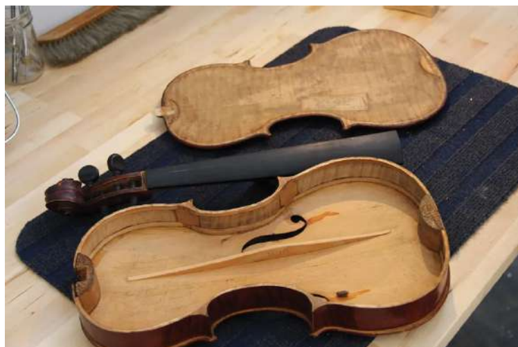
Imatge 19: Barra harmònica col·locada a la caixa oberta d'un violí.
