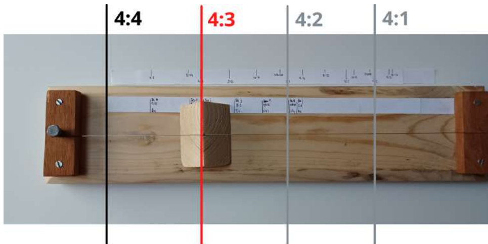
Imatge 66: Obtenció de la proporció 4:3 en el monocordi
