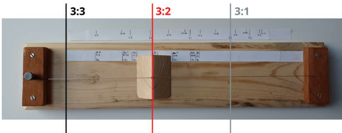
Imatge 65: Obtenció de la proporció 3:2 en el monocordi
