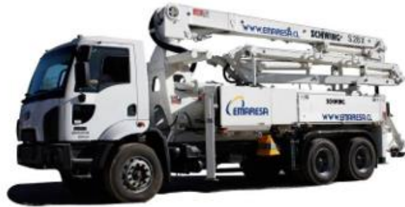
Figura 176: Bomba de formigonat. Font: Web Maquiclick
