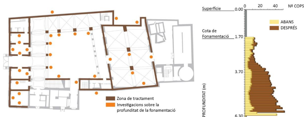
Fig. 21 D'esquerra a dreta. Plànol de la intervenció al Palatium Vetus. Resultats dels assajos de penetració abans i després de la intervenció al Palatium Vetus. Font: Uretek®
