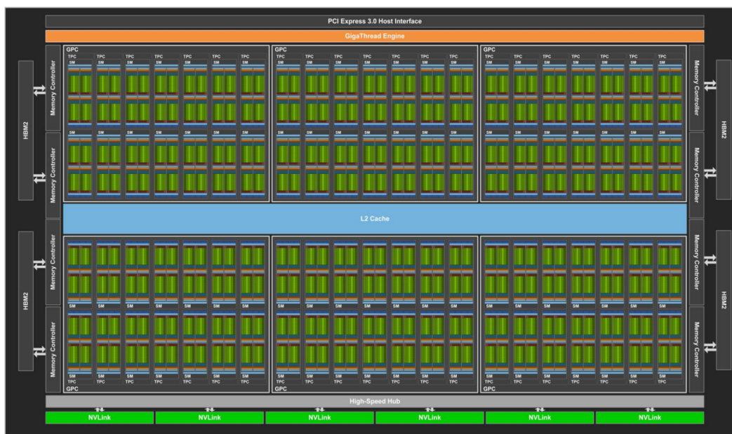
FIGURA 5.1: Arquitectura d'una GPU de NVIDIA de la generació Volta
