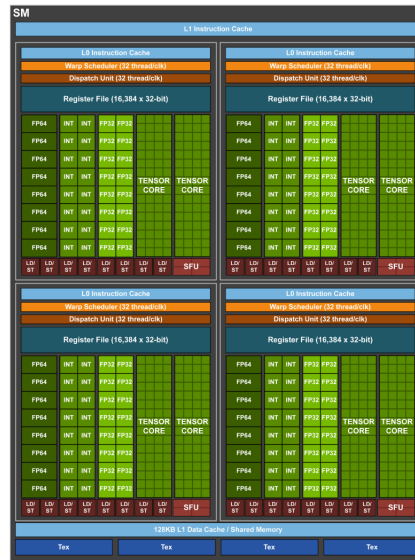
FIGURA 5.2: Arquitectura processador SM d'una GPU de NVIDIA de la generació Volta
