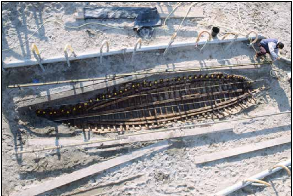
Fig. 1. Vista zenital del derelict Sorres X, popa a l'esquerra i proa a la dreta. Es podem observar les diferents quaderns, la paramola recolzada sobre el paramitjal al centre i dues serres a cada banda. (Autor: Xavier Nieto, reproduïda a PUJOL 2016).
