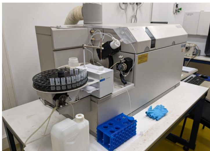
Figura 3. ICP-MS Agilent 7500c situat als Serveis Tècnics de Recerca de la UdG. Font pròpia.
