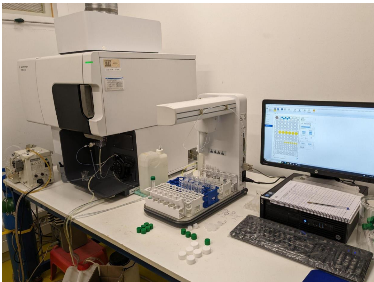
Figura 5. ICP-OES Agilent 5100 amb mostrejador automàtic dels Serveis Tècnics de Recerca de la UdG. Font pròpia.
