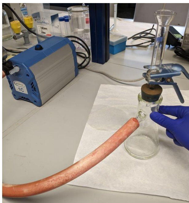
Figura 2. Muntatge per filtrar al buit. A l'esquerra s'observa la bomba de buit, connectada al kitasato amb la placa filtrant i l'embut de vidre. Font pròpia.
