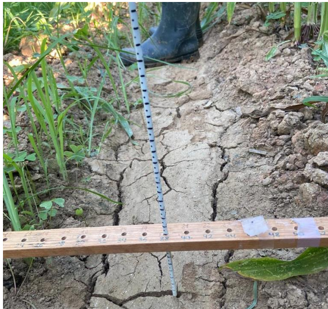
FIGURA 15: Lectura del perfil del solc amb l'ajuda del perfilòmetre. FONT: Pròpia.
